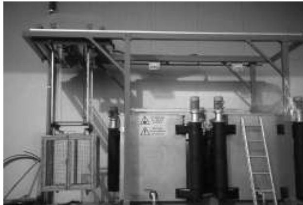
Fig. 8 – Premoltiplicazione del materiale di "base" presso il CEPREMAVI: marze e portinnesti sono termotrattati in acqua come misura utile a consentire le massime garanzie di sanità per le barbatelle da fornire ai vivaisti.
