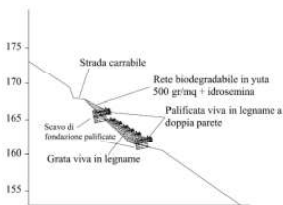
Fig. 7 - Sezione tipo di sistemazione di movimento franoso.
