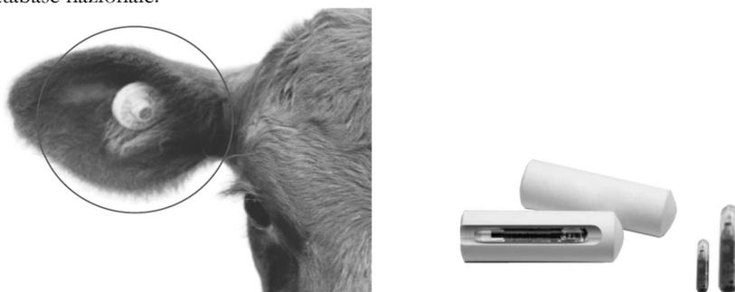
Fig. 2 - Identificatori RFID per animali (LF, 134 kHz). A sinistra: auricolari; a destra: boli endoruminali e dispositivi iniettabili
