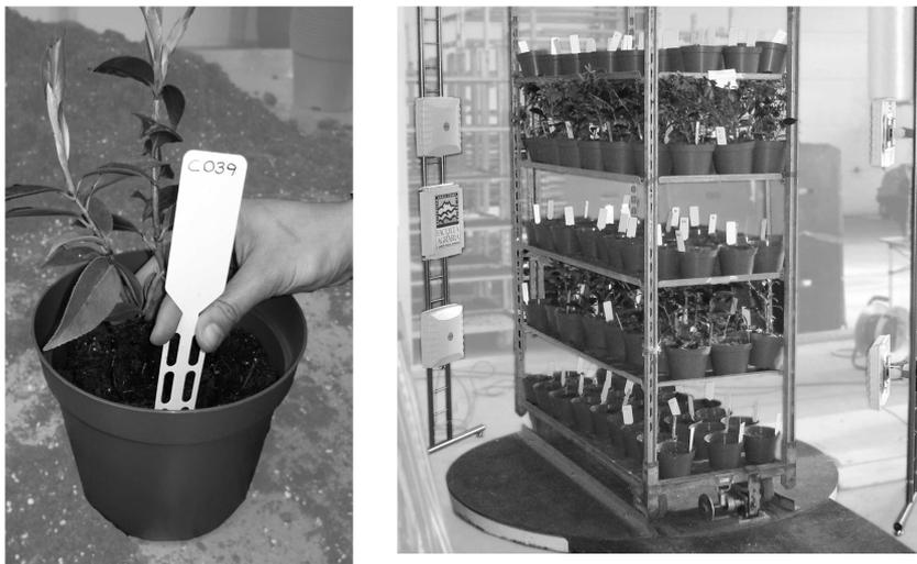
Fig. 4 - Identificazione elettronica di piante di camelia. A sinistra, inserimento dell'etichetta elettronica (UHF) con sistema di ancoraggio radicale. A destra, identificazione di 120 piante di camelia su carrello rotante.
