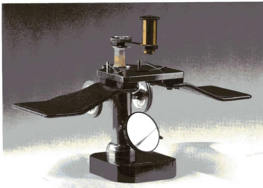
Foto 1 - Microscopio da dissezione Carl Zeiss, Jena, con ottiche intercambiabili, poggia-mani, specchietto piano e concavo per transilluminazione. Lascito Mylius.
