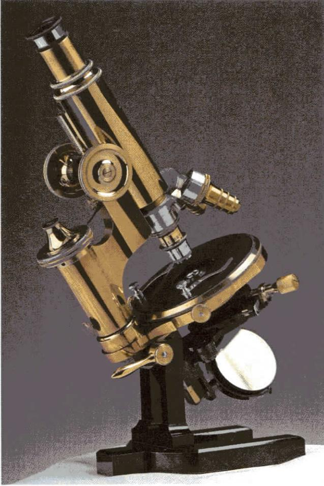
Foto 10 - Microscopio biologico Carl Zeiss, Jena, modello 1a n. 15799, in doppia cassetta di legno con accessori fra i quali il diaframma per campo oscuro, l'oculare micrometrico e il vetrino micrometro oggetto. Lascito Mylius.
