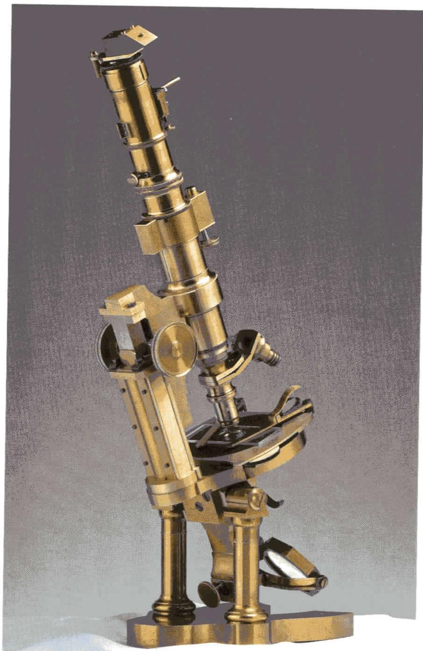
*Foto 4 - Microscopio biologico Nacet, Paris grand modèle perfectionné, montato per osservazioni dall'alto, dotato di camera lucida per disegno, micrometro e revolver per due obiettivi. Lascito Vasco.*
