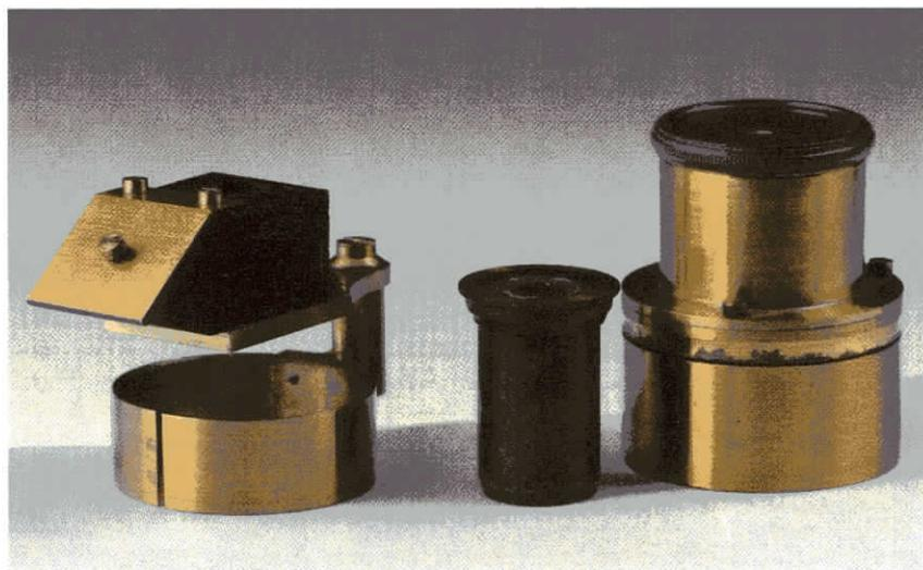
Foto 9 - A sinistra camera lucida a prisma per disegnare gli oggetti osservati al microscopio, a sinistra sistema ottico per luce polarizzata con prismi di Nicol sia al condensatore, cilindro nero, sia da sovrapporre all'oculare.
