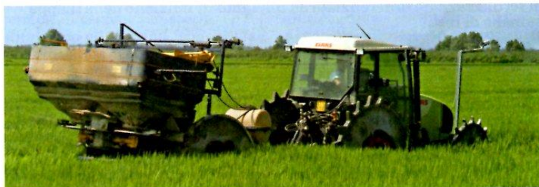
Foto 1 Trattoria e spandiconcime impiegati per effettuare la modulazione in tempo reale della concimazione azotata nella fase di differenziazione della pannocchia. Si noti il sensore NDVI, collocato anteriormente alla trattoria
